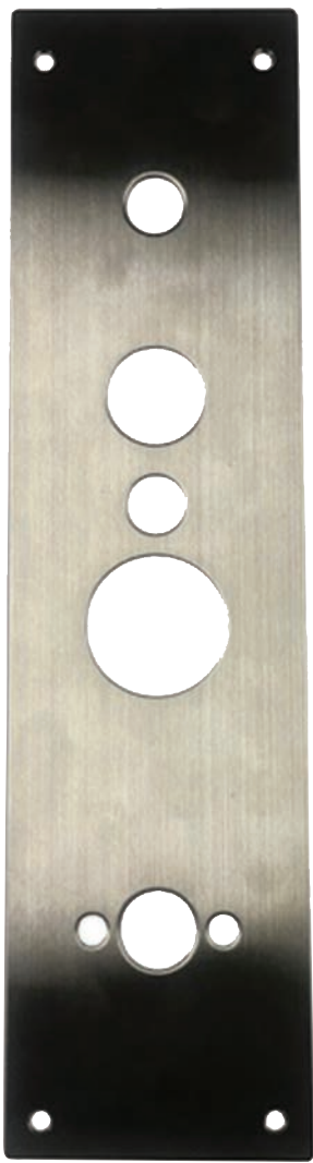
A=4×D6皿下穴 4.2mm 板厚t=1.5 sus304ヘアライン縦目仕上げ
